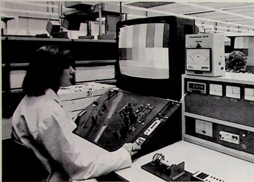
Bild 6. Ein Reparatur- und Kontrollplatz im Modulreparatur-Zentrum des Zentralkundendienstes von Grundig mit adaptierbaren Meß- und Prüfgeräten für die Instandsetzung der Austauschmodule
